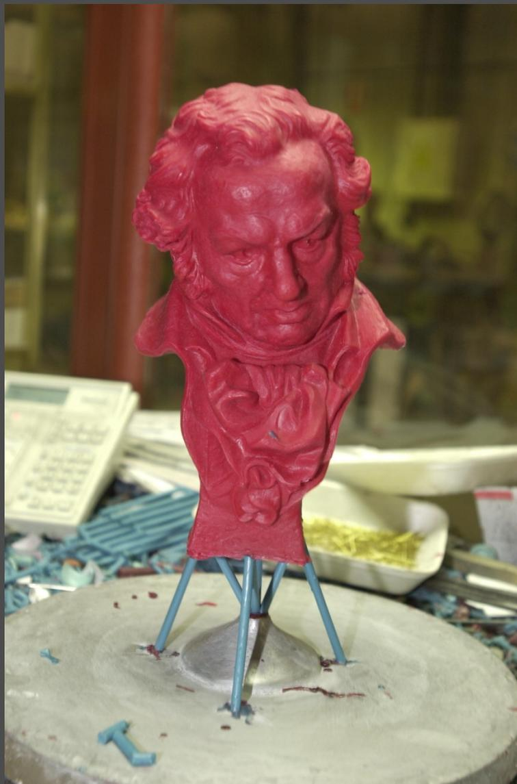
13--Montaje para la fundición
