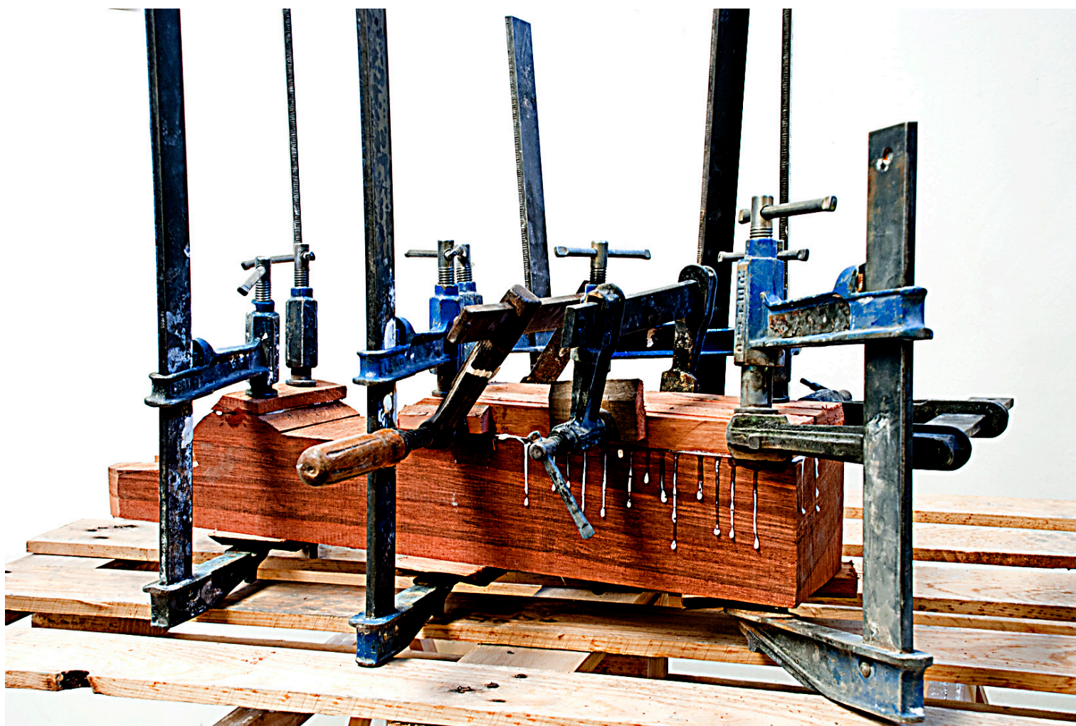
Encolado del bloque para la talla
